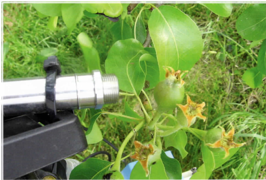
Obr. 3 – Měření povrchové teploty plůdku hrušně
