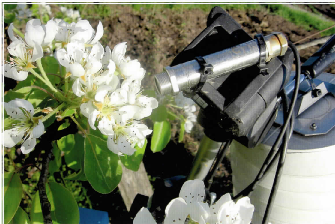
Obr. 2 – Měření teploty květů hrušně infračerveným teploměrem
