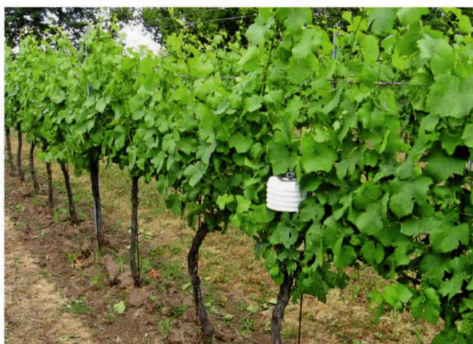
Obr. 7: Ukázka umístění registrátoru teploty vzduchu v plastovém stínítku ve vinohradu
