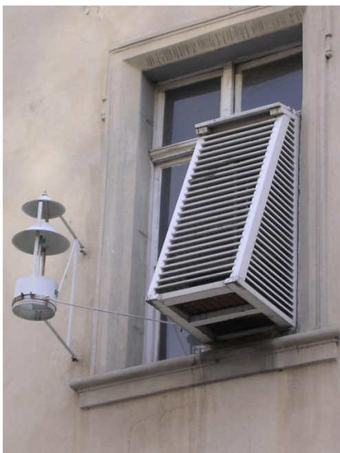
Obr. 4 Detail umístění teploměrů v pražském Klementinu
