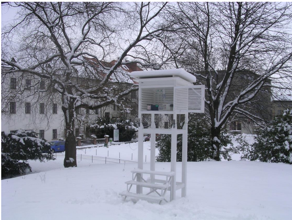
Obr. 3 Meteorologická budka s automatickou stanicí včetně standardního vybavení pro demonstrační účely
