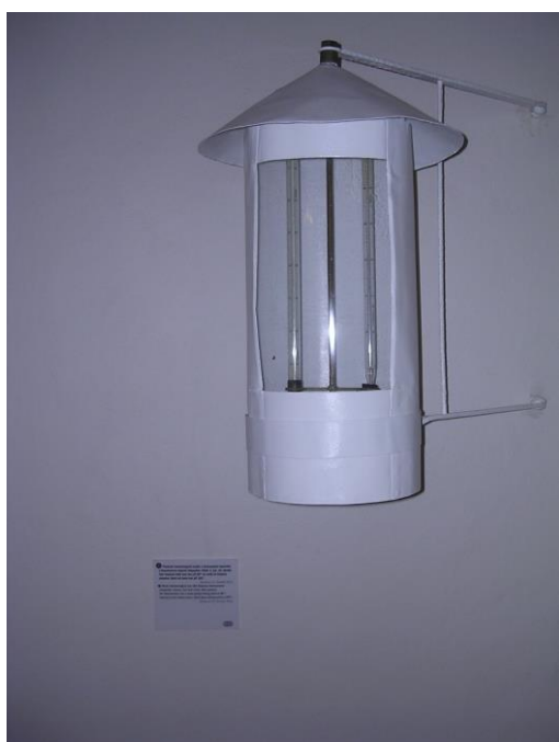
Obr. 2 Plechová budka s teploměry fy. Kappeller, používaná G. J. Mendelem
